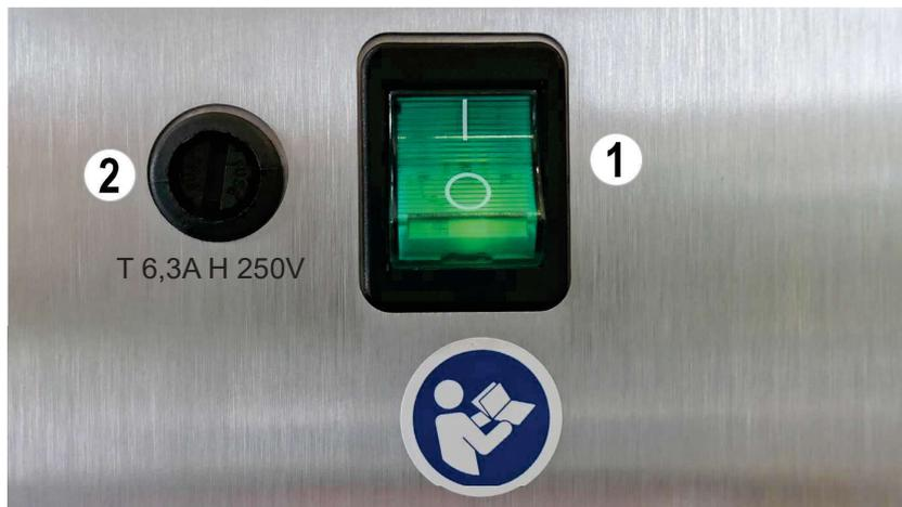
La unidad de tratamiento dispone de un interruptor ① de red en la base del sillón. El interruptor de red conecta la unidad de tratamiento con la red eléctrica. Si la unidad no se va a utilizar durante un período de tiempo prolongado, se debe desconectar la fuente de alimentación.
